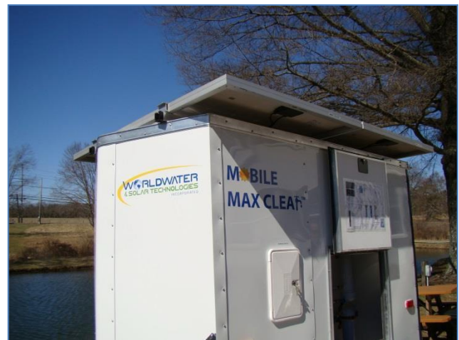
720 watts intégrés sur la remorque
