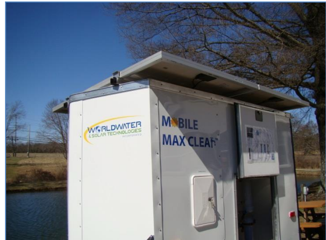
720 vatios integrados en el remolque
